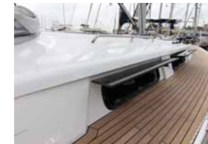
I grandi oblò sulla tuga si aprono verso l'esterno: se da una parte ci si può urtare camminando in coperta (ma in quel punto i passavanti sono larghi), dall'altra possono essere aperti anche quando piove
