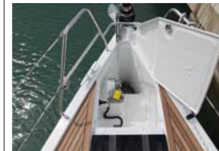
Il grande portello nasconde un pozzo per la catena nella norma, seppur profondo; il resto dello spazio è dedicato a un vano dove poggiare attrezzatura che però non ha un bordo di contenimento
