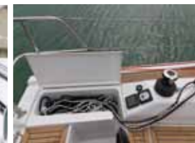
Data l'abbondanza di cime rinviate a poppa, sono stati ricavati due vani per raccogliere le varie code, evitando l'effetto spaghetti in pozzetto
