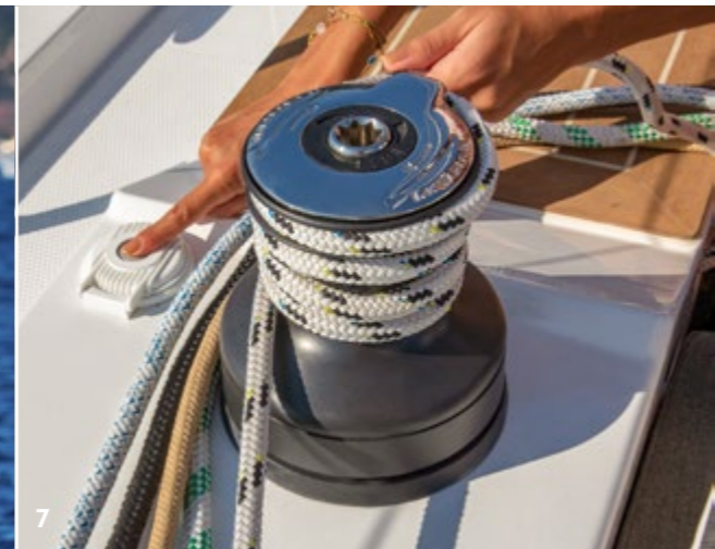
1 Solarzelle auf dem Decksaufbau 2 Raymarine Quantum 2 Radar 3 2 Cockpittische mit Teakplatte, elektrisch absenkbar zu Liegefläche inkl. Polster 4 Gashebel am Instrumententräger 5 Zwei GFK-Steuerräder, Y-Speichen (schwarz oder weiß) 6 Delta-Anker 16 kg, Edelstahl, mit Wirbel und 60 m Edelstahlkette 7 2 LEWMAR 45 EST EVO Fallwinschen, elektrisch mit Sicherungsautomat 8 Badeplattform, manuell ausklappbar mit Badetreppe 9 Lazy-Bag mit Lazy-Jacks
