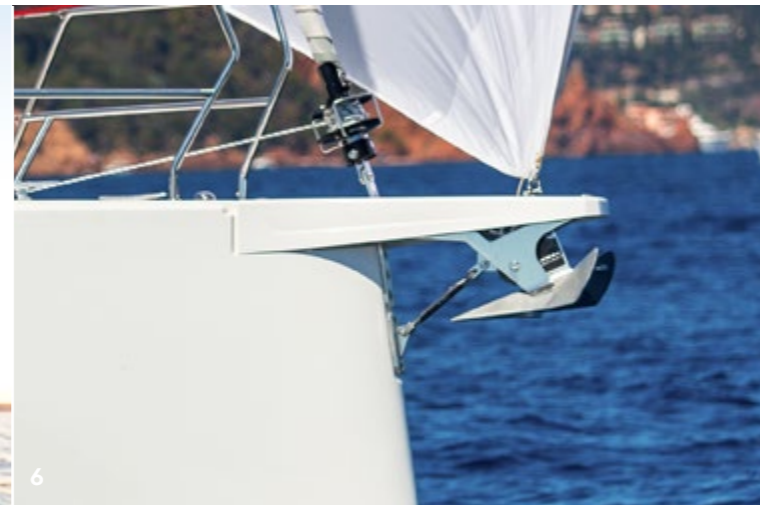
1 Solarzelle auf dem Decksaufbau 2 Raymarine Quantum 2 Radar 3 2 Cockpittische mit Teakplatte, elektrisch absenkbar zu Liegefläche inkl. Polster 4 Gashebel am Instrumententräger 5 Zwei GFK-Steuerräder, Y-Speichen (schwarz oder weiß) 6 Delta-Anker 16 kg, Edelstahl, mit Wirbel und 60 m Edelstahlkette 7 2 LEWMAR 45 EST EVO Fallwinschen, elektrisch mit Sicherungsautomat 8 Badeplattform, manuell ausklappbar mit Badetreppe 9 Lazy-Bag mit Lazy-Jacks
