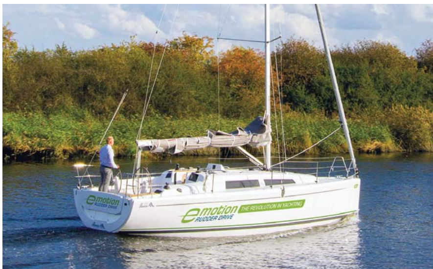
Hanse 315 e-motion rudder drive. Napęd rozpędza łódź do prędkości 4,5 węzła.
